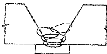
(ب) عرض ریشه برای پاس بعدی در حد فاصل لبه ورق و نوار جوش وجود ندارد و احتمال ذوب ناکافی موجود می‌باشد
